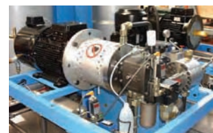
bezobsługowa instalacja pompy dozującej polioliu oraz izocyjanianu w wysokociśnieniowych wtryskarkach PUR
